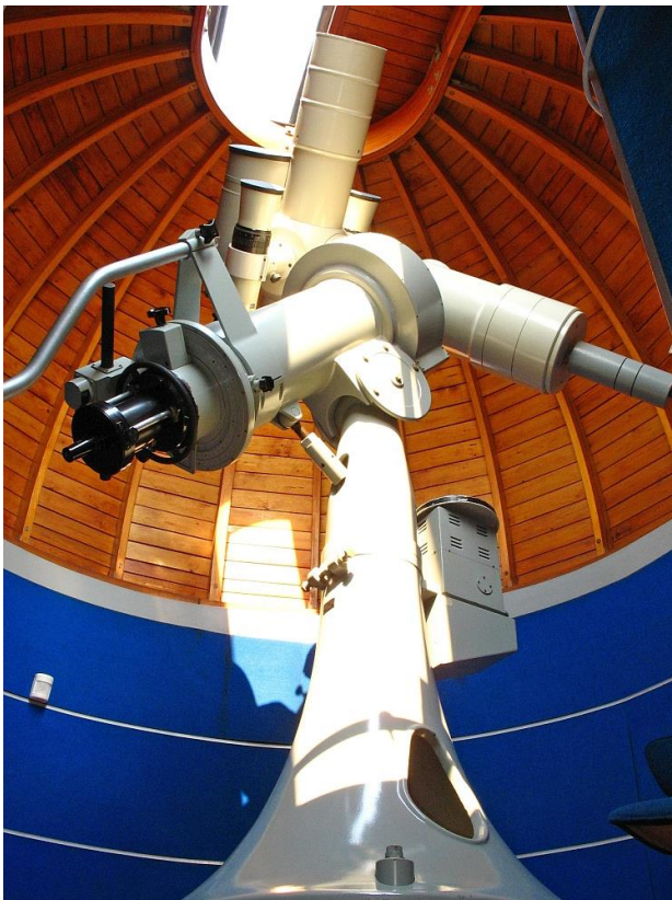
A csillagvizsgáló fő műszere a Zeiss Coudé refraktor
