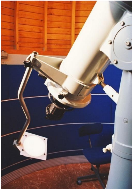
A napfoltok észlelése és rajzolása kivetítéssel a Zeiss Coudé refraktorról
