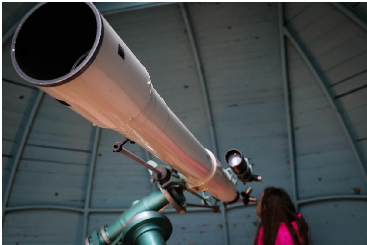
A csillagvizsgáló főműszere 135/1760 mm refraktor
